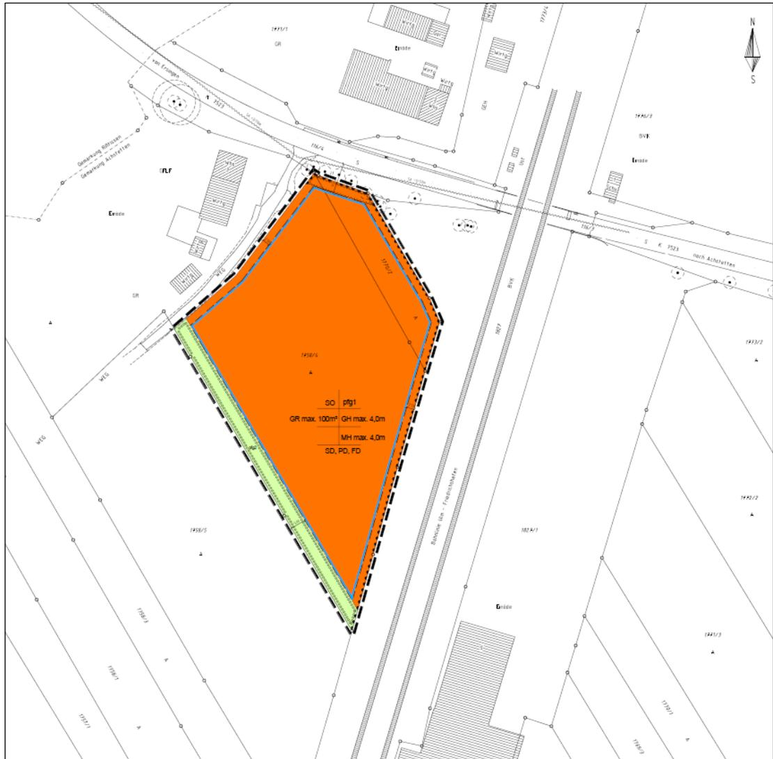
Entwurf des Bebauungsplans „Freiflächenphotovoltaikanlage Einöde“ vom 11.03.24, ohne Maßstab
