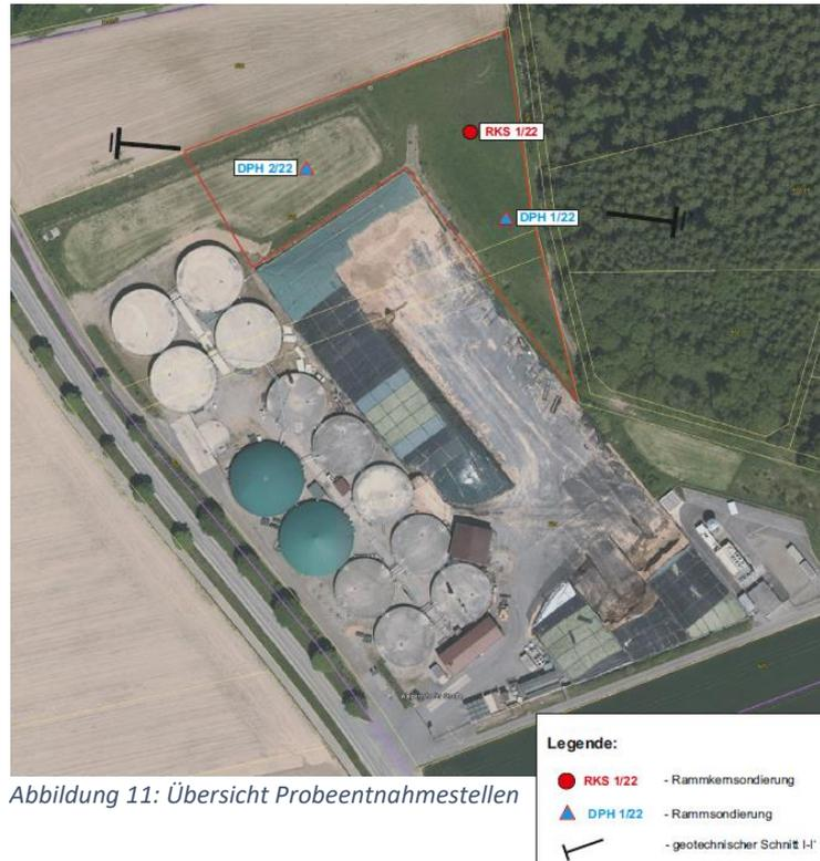
Abbildung 11: Übersicht Probeentnahmestellen
