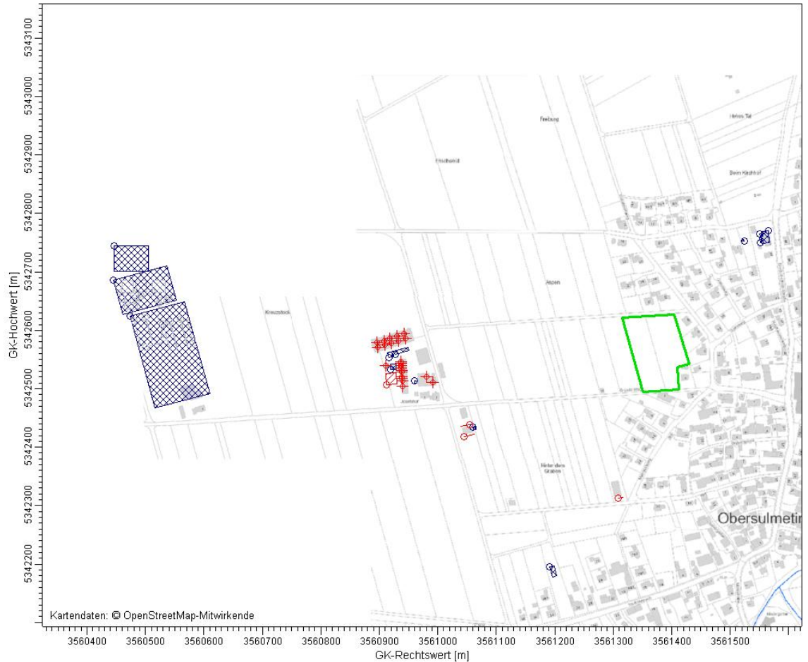
Abbildung 6. Lage der Emissionsquellen (Volumenquellen: schwarz, vertikale u. horizontale Flächenquellen: rot, Punktquellen: rotes Kreuz), Plangebiet grün umrandet. Hintergrundkarte: Geobasisdaten © LGL, LUBW [5]. Untersuchungsfall Variante I
